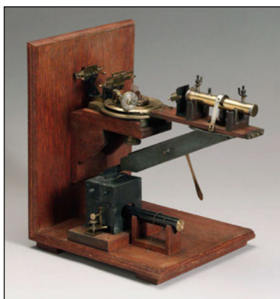
Figure 1. Premier spectromètre à rayons X conçu par Sir William Lawrence Bragg (1890-1971). Il fut le premier à montrer en 1921 que la structure moléculaire peut être déduite à partir du cliché de diffraction des rayons X par un échantillon de cristal.
